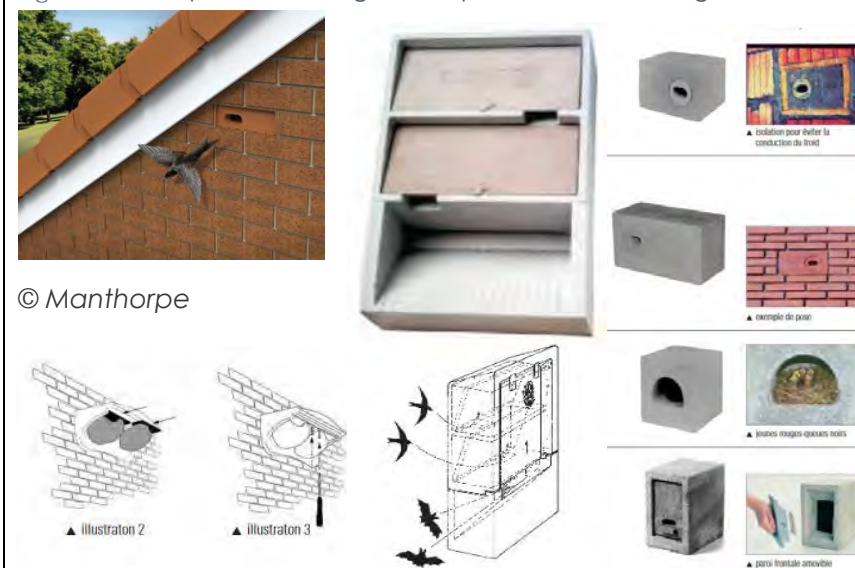
Figure 16 Exemples d'aménagements pouvant être envisagés
